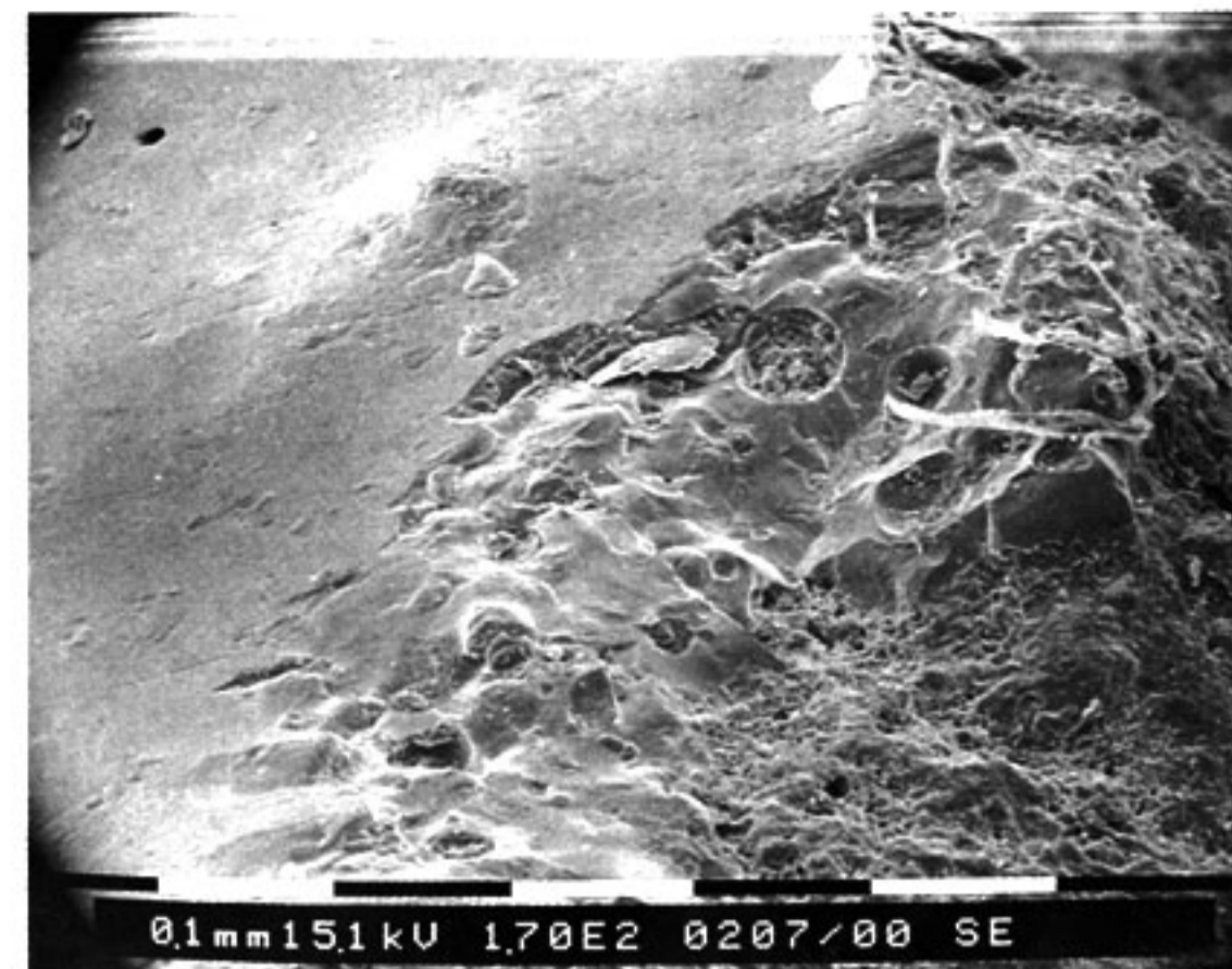
Fig. 36c - Microfotografia dell'invetriatura presente sulla superficie interna e del corpo ceramico sottostante (S. E. M. 103 ×).
